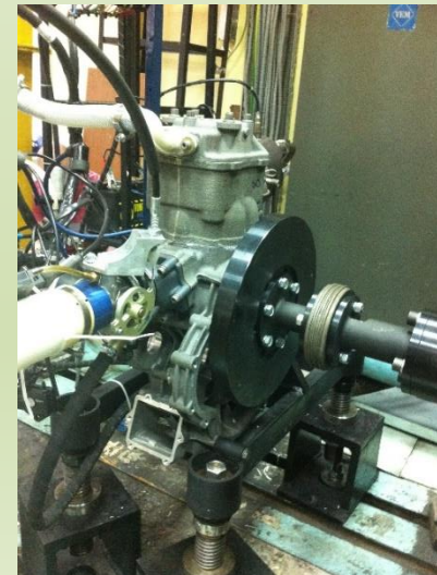
Стенд для моторных испытаний
