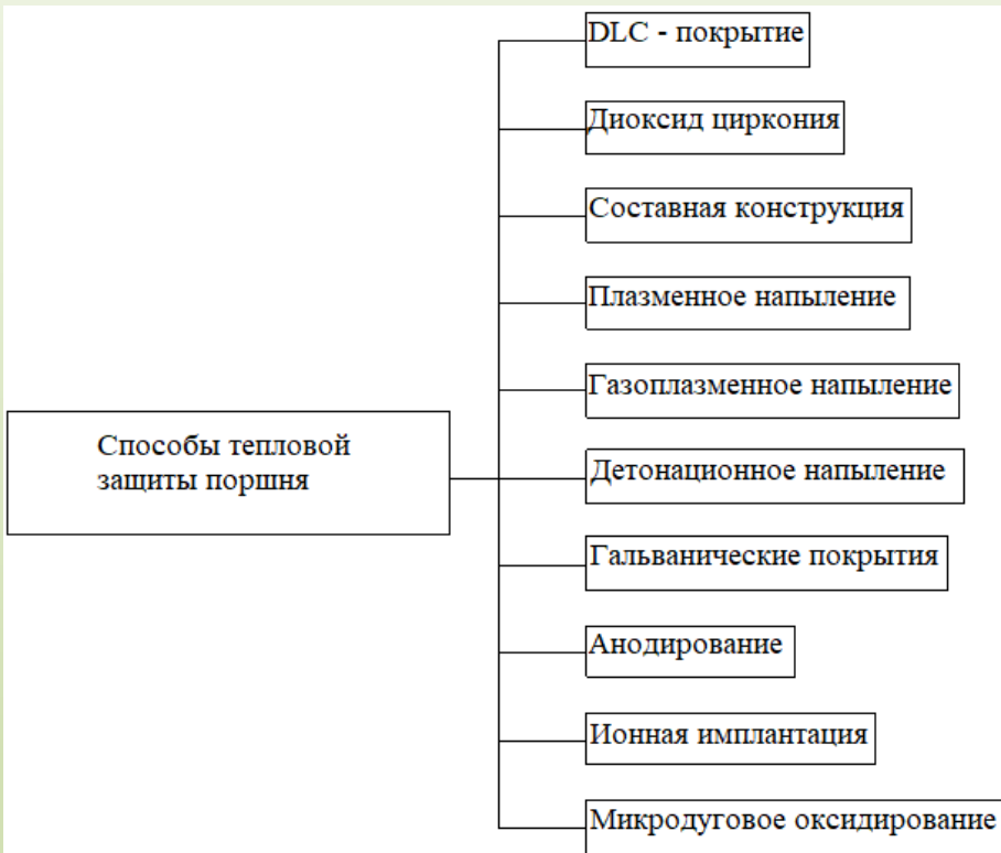
Рис. 1 - Классификация методов тепловой защиты поршней
