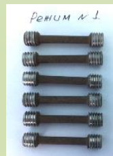
Рис. 4 – Лабораторные образцы после МДО перед испытаниями на: а - термостойкость и коррозионную стойкость; б – на изгиб, в – на прочность
