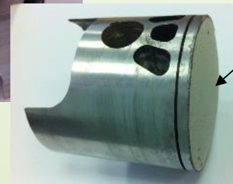
Рис. 8 – Поршни АПД: а – без МДО; б – с МДО-слоем
