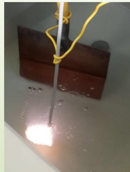
Рис.1 – Образец в процессе МДО
