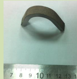
Рис. 5 – Образцы после испытаний на 3-х точечный изгиб
