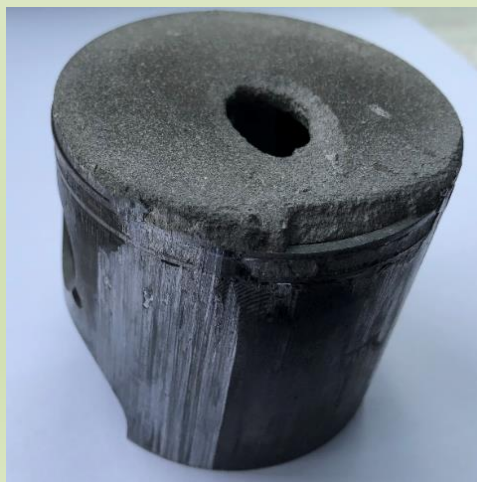
Рис. 2 – Поршень с прогаром
