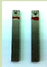
Рис. 4 – Лабораторные образцы после МДО перед испытаниями на: а - термостойкость и коррозионную стойкость; б – на изгиб, в – на прочность
