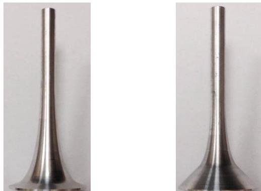
Образцы клапанов для холодной продувки
