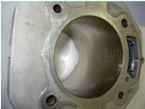
Препарированный цилиндр с установленными датчиком толщины МС
