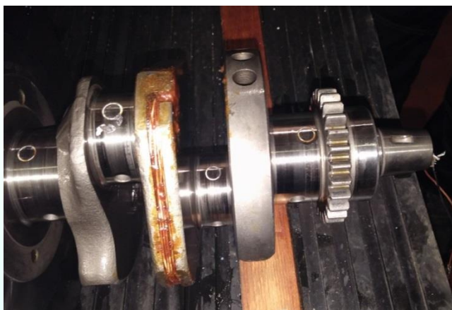
Препарированный КВ с установленными датчиком толщины МС
