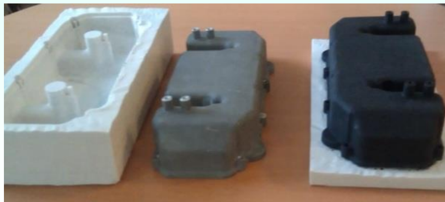
Крышка двигателя-демонстратора мощностью 90 л.с. (ПД-1400)
