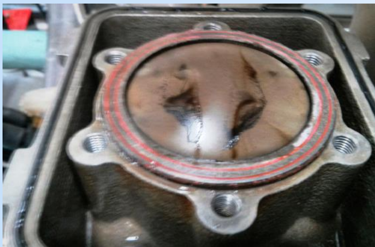
Рис. 2. Поршень № 3 (с МДО-слоем) в цилиндре двигателя после испытаний
