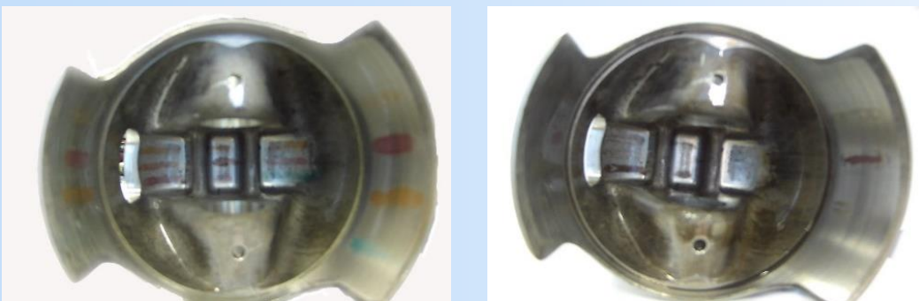
Рис. 1. Поршень №3 с термоиндикаторами до и после испытаний: а – внутренняя поверхность поршня до испытаний; б – внутренняя поверхность поршня после испытаний
