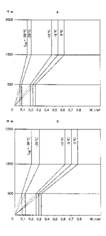
Рис. 2. Зависимость водности от вертикальной протяженности зоны обледенения а — L = 200 км; б — L = 32 км
