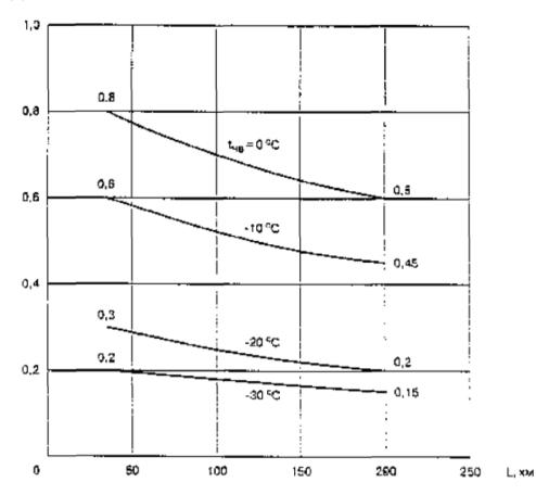
Рис. 1. Зависимость водности от горизонтальной протяженности зоны обледенения в условиях максимального длительного обледенения в диапазоне высот от 0 до 9500 м для облаков (слоистообразных) с максимальной вертикальной протяженностью 2000 м и среднеарифметическим диаметром капель 20 мкм
