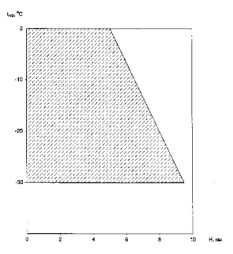
Рис. 3. Зона возможного обледенения, определяемая высотой и температурой наружного воздуха, для условий максимального длительного обледенения
