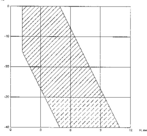
Рис. 5. Зона возможного обледенения, определяемая высотой и температурой наружного воздуха, для условий максимального кратковременного обледенения.
