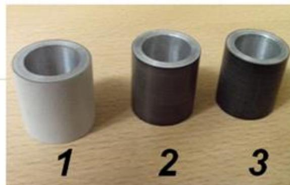
Рис.1. Этапы подготовки упрочненных поверхностей
