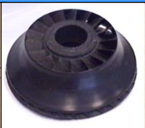
РК КВД составной конструкции открытого и закрытого типа из КМ
