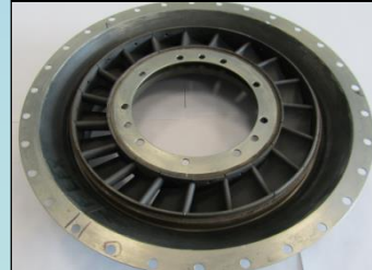
Сопловой аппарат из керамического КМ алмаз/SiC
