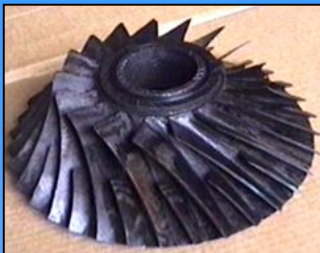
РК КВД составной конструкции открытого и закрытого типа из КМ
