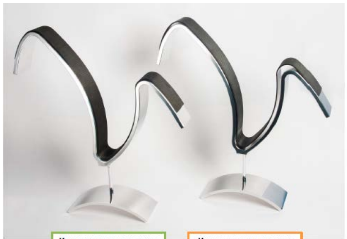
Изготовлено на оснастке с компенсацией коробления
