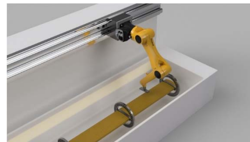
Концепция роботизированного ультразвукового томографа лонжеронов
