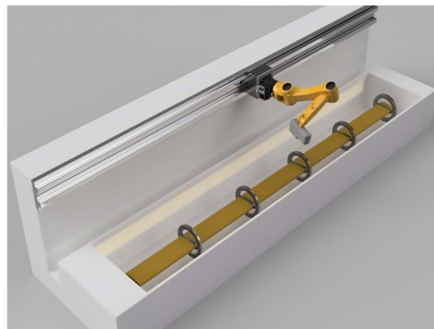
Концепция роботизированного оптического профилометра
