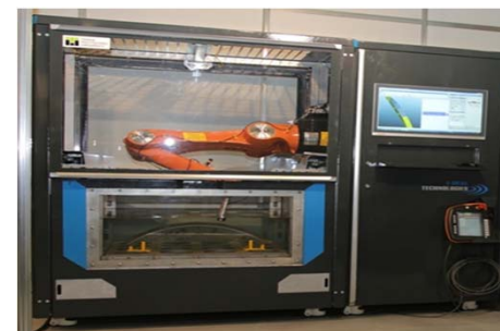
Роботизированная система ультразвуковой томографии
