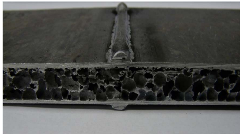
Общий вид стыкового узла
