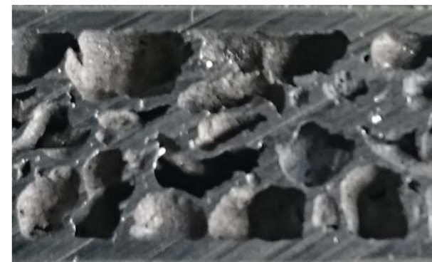
Сэндвич с алюминиевой пеной в поперечном сечении, сверху - невспененное, снизу - вспененное состояние
