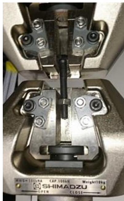
Испытание крепежных элементов из стали (слева) и ПКМ (справа)
