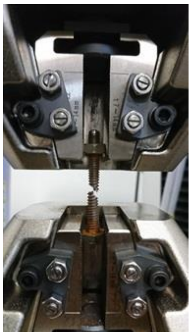
Испытание крепежных элементов из стали (слева) и ПКМ (справа)
